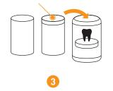
Sgancio della piattaforma di stampa, scorrimento all'interno del cilindro di recupero, posizionamento della nuova piattaforma di stampa, avvio del successivo ciclo di stampa.
